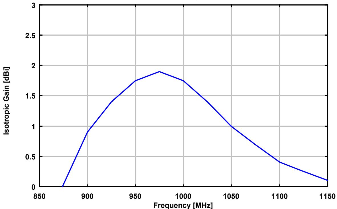
Antennenwandlungsmaß, Elementlänge 140 mm, Kurzschlußschieber entfernt
