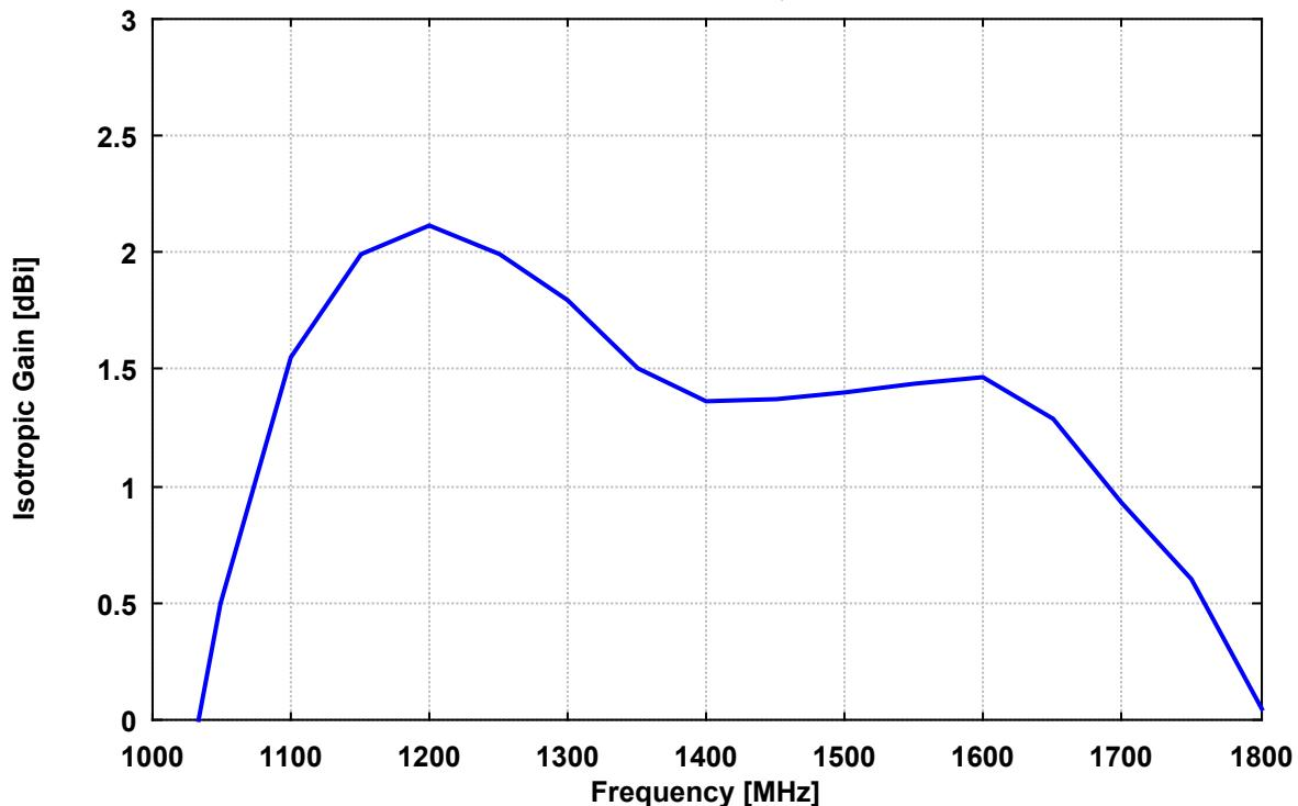
Antennenwandlungsmaß, Elementlänge 114 mm, Kurzschlußschieber entfernt
