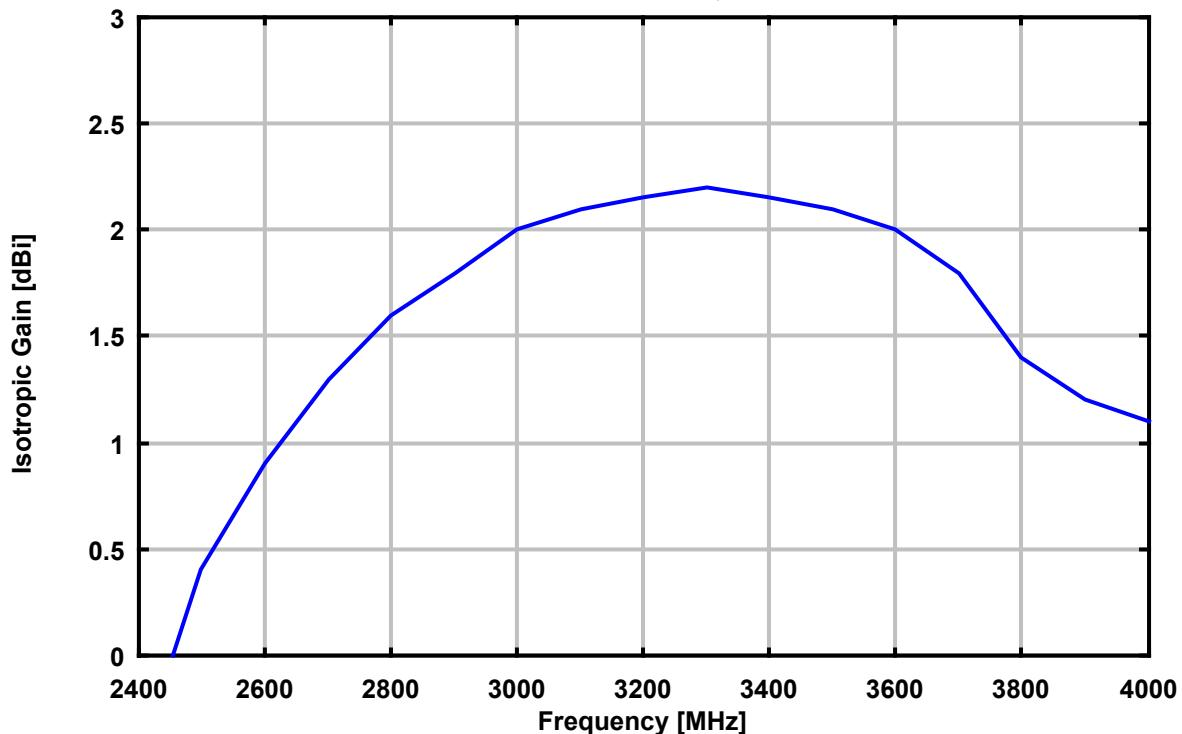
Antennenwandlungsmaß, Elementlänge 48 mm, Kurzschlußschieber 24 mm
