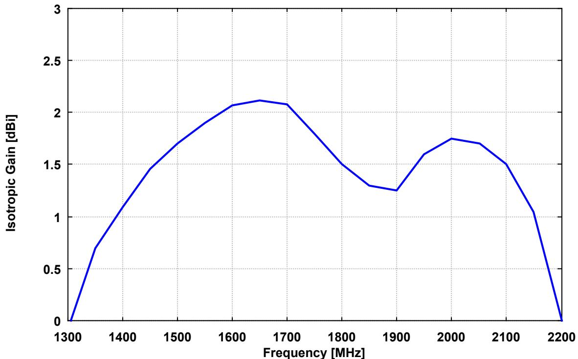
Antennenwandlungsmaß, Elementlänge 90 mm, Kurzschlußschieber 45 mm
