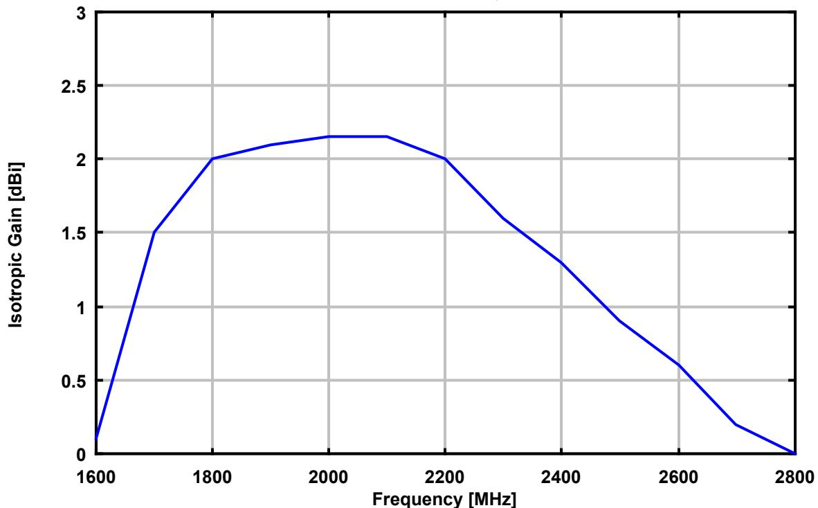
Antennenwandlungsmaß, Elementlänge 72 mm, Kurzschlußschieber 36 mm
