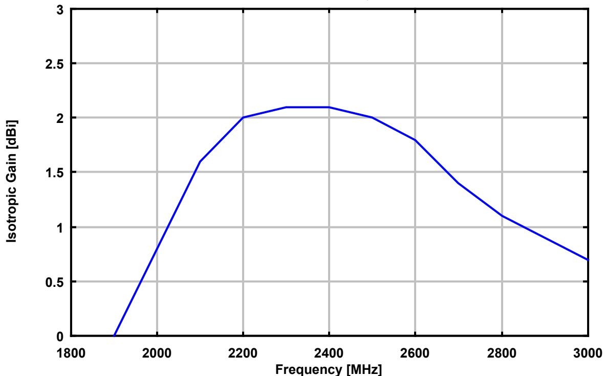
Antennenwandlungsmaß, Elementlänge 60 mm, Kurzschlußschieber 30 mm
